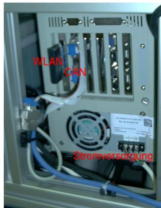
Abbildung 2.1: Rückseite des Roboterrechners mit Beschriftung
