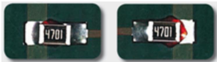
Nachweis nur durch visuelle Kontrolle möglich. Besonderes Problem: Nach einem Ausfall der Baugruppe z.B. bei Vibration in einem Fahrzeug ist sofort erkennbar, dass es sich um einen Fertigungsfehler handelt, der (optisch) erkennbar gewesen wäre. Fall für Produkthaftung.
