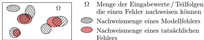
Bei fehlerunabhängiger (zufälliger) Testauswahl sind die Wahrscheinlichkeiten das die Nachweismenge eines Fehlers oder Modellfehlers »getroffen« wird, von der Größe der Nachweismengen und den Wahrscheinlichkeiten, mit denen die einzelnen Eingaben ausgewählt werden ab.
