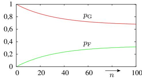
Für große  $n$  strebt der Reparaturprozess gegen den stationären Zustand:
