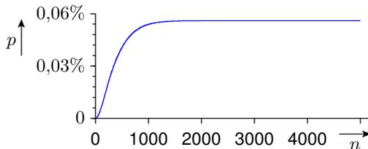
Die FF-Rate nimmt anfangs mit der Testsatzlänge zu und bleibt ab  $n_K \geq 2000$  konstant  $p \approx 0,057\%$ .
