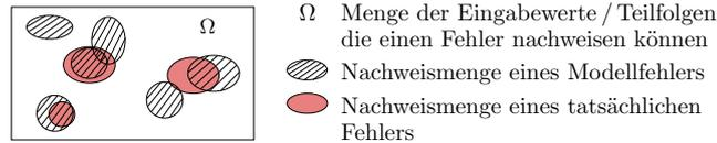
Bei fehlerorientierter Testauswahl wird für jeden Modellfehler mindestens ein Test gesucht, der ihn nachweist. Ein tatsächlicher Fehler  $i$  wird von jedem für einen ähnlich nachweisbaren Modellfehler gefundenen Test  $j$  mit einer Wahrscheinlichkeit  $p_{ij}$  nachgewiesen:
