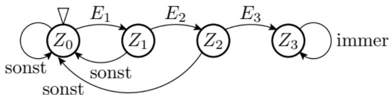
Zur Umwandlung in eine Markov-Kette werden die Übergangsbedingungen durch die Übergangswahrscheinlichkeiten  $p_{E_1}$  bis  $p_{E_3}$  und die Zustände durch Zustandswahrscheinlichkeiten  $p_{Z_i}$  ersetzt.
