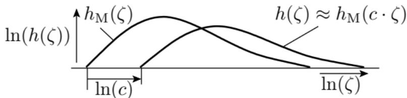
Die FF-Dichten der Fehler und Modellfehler sind tendentiell um einen Faktor  $c$  zueinander verschoben:
