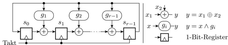
Für jede Bitanzahl  $r$  des Zustandsvektors gibt es Konstanten  $\mathbf{g}$ , sog. »primitive Polynome«, bei denen alle Zustände außer  $000\dots 0$  ineinander übergehen. Nur solche Konstanten  $\mathbf{g}$  werden verwendet.
