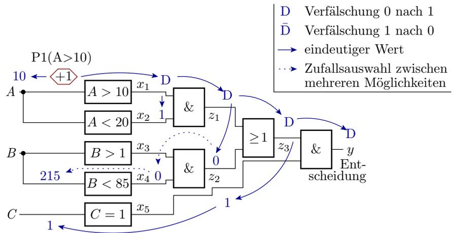
Für den »+1«-Fehler ist am Fehlerort ein Wert einzusetzen, bei dem sich Erhöhung um eins das Vergleichsergebnis ändert. Vom Vergleichsergebnis wird ein D-Pfad zum Entscheidungsausgang durch zurücktreiben von Steuerpfaden zu Eingängen sensibilisiert.
