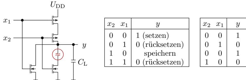
Unterbrechung innerhalb eines Gatters, so dass der Gatterausgang für bestimmte Eingaben nicht auf- bzw. entladen wird.
