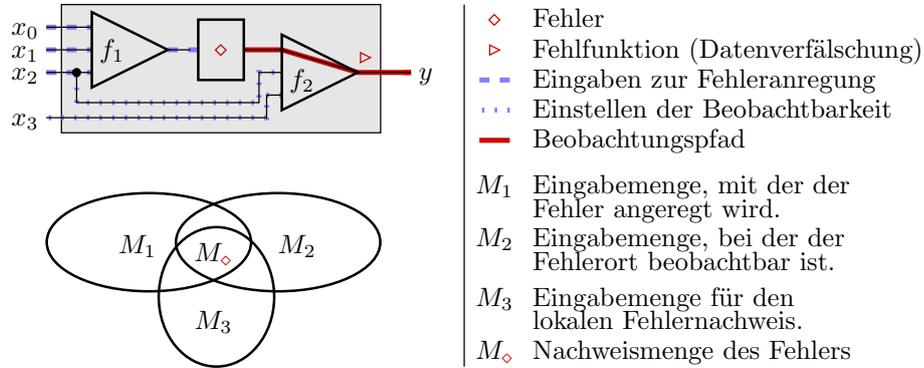
Die Nachweismenge eines (Modell-) Fehlers ist die Schnittmenge der Eingabemengen, die die einzelnen Nachweisbedingungen erfüllen.
