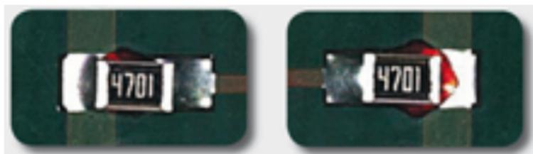
Nachweis nur durch visuelle Kontrolle möglich. Besonderes Problem: Nach einem Ausfall der Baugruppe z.B. bei Vibration in einem Fahrzeug ist sofort erkennbar, dass es sich um einen Fertigungsfehler handelt, der (optisch) erkennbar gewesen wäre (siehe Produkthaftung, TV\_F2, Abschn. 4.4).
