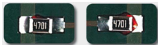
Nachweis nur durch visuelle Kontrolle möglich. Besonderes Problem: Nach einem Ausfall der Baugruppe z.B. bei Vibration in einem Fahrzeug ist sofort erkennbar, dass es sich um einen Fertigungsfehler handelt, der (optisch) erkennbar gewesen wäre (siehe Produkthaftung, Seite 3).
