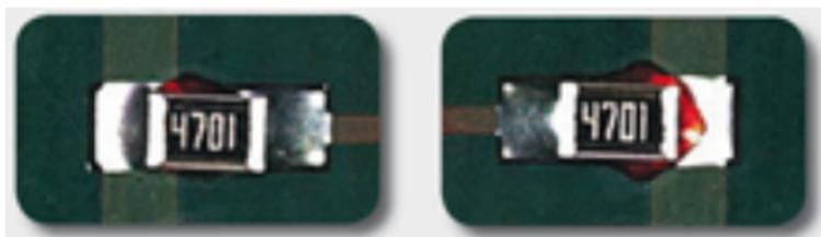
Nachweis nur durch visuelle Kontrolle möglich. Besonderes Problem: Nach einem Ausfall der Baugruppe z.B. bei Vibration in einem Fahrzeug ist sofort erkennbar, dass es sich um einen Fertigungsfehler handelt, der (optisch) erkennbar gewesen wäre, so dass der Hersteller auch für alle Folgeschäden, z.B. Unfallschaden, haftet.
