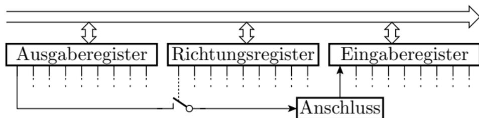
Ports (Parallel Schnittstellen) sind EA-Register mit direkt anschließbaren Leitungen z.B. für Schalterein- LED-Ausgaben.
