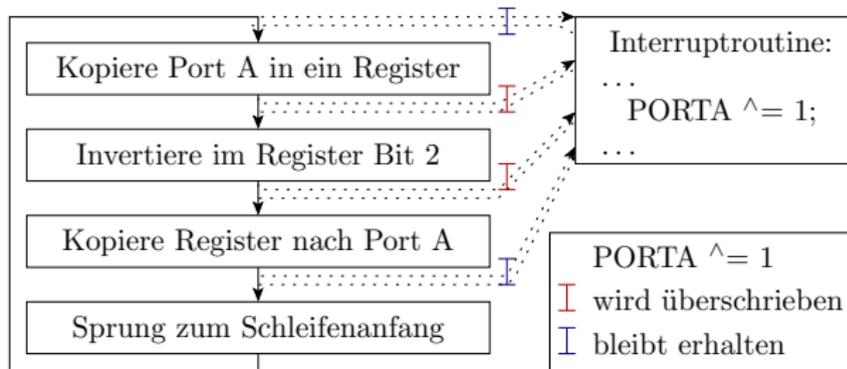
An 50% der Unterbrechungsmöglichkeiten wird die Invertierung von PA.0 in der ISR vom Rückschreibwert für die Invertierung von PA.1 überschrieben, d.h. Reaktion nur auf 50% Tastendrucke.
