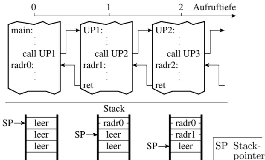
Die Rückkehradressen werden auf einem Stapelspeicher (Stack) nach dem Prinzip »Last In First Out« gespeichert und beim Rücksprung wieder entnommen. Nach diesem Prinzip können Unterprogramme selbst Unterprogramme verwenden.
