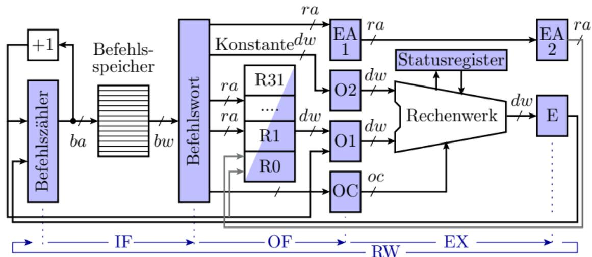
Bei Ausführung eines Sprungs wird der Befehlszähler in der IF-, der OF- und der EX-Phase incrementiert. Erst nach der RW-Phase steht das Sprungziel im Befehlszähler<sup>3</sup>.
