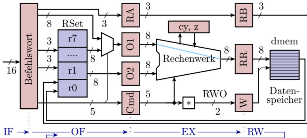
\* Bildung des 2-Bit-RWO-Codes für die RW-Phase ( $RWO \in \{-, R, L, S\}$  für kein Ergebnis speichern, Ergebnis in Register speichern, Lade- oder Speicheroperation).
