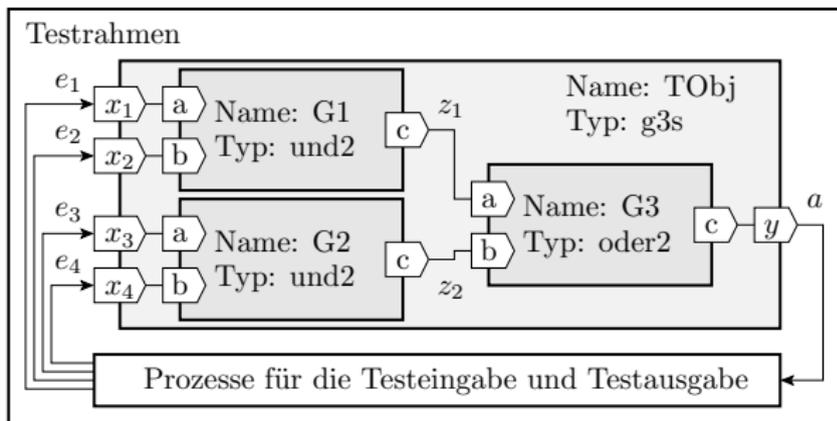
Das oberste Hierarchieelement einer Simulation ist der Testrahmen (Testbench). Er besteht im Wesentlichen aus einer Instanz des Testobjekts, Vereinbarungen der an das Testobjekt angeschlossenen Signale sowie Prozessen zur Bereitstellung der Testeingaben und Auswertung der Testausgaben.
