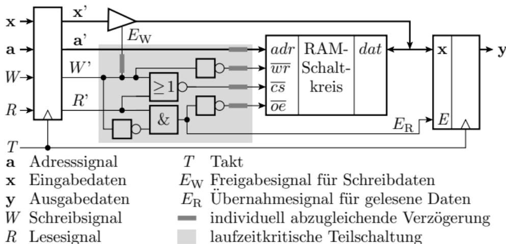
Für die Nutzung eines SRAMs ist eine Schnittstellenschaltung mit dem grau unterlegten laufzeitkritischen Teil zu entwickeln<sup>11</sup>.
