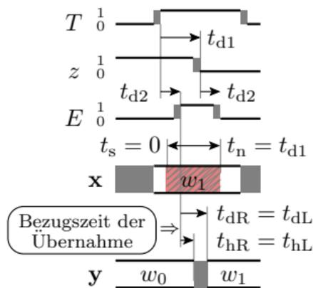
Erzeugung eines kurzen Freigabeimpulses für ein Latch an der aktiven Taktflanke. Halbe Latch-Anzahl gegenüber Master-Slave-Lösung. Empfindlicher gegenüber Laufzeitungenauigkeiten, d.h. schwerer zu entwerfen. Eingabedaten brauchen keine Vorhaltezeit ( $t_s = 0$ ), dafür eine Nachhaltezeit ( $t_n > 0$ ).
