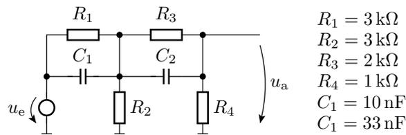
**Aufgabe 2.2:** Gegeben ist eine RC-Schaltung und ein rechteckförmiger Eingangsspannungsverlauf.
