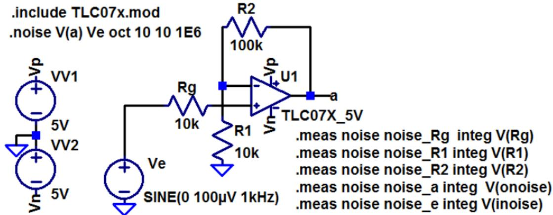
Bestimmen Sie die Rauschdichten und die effektiven Rauschspannungen im Frequenzbereich von 10 Hz bis 1 MHz für
