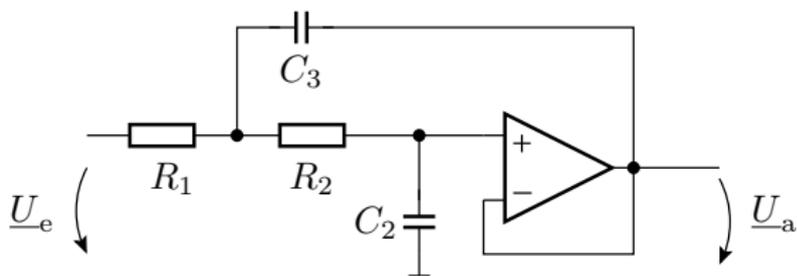
$$\frac{U_a}{U_e} = \frac{1}{1 + j\omega \cdot C_2 \cdot (R_1 + R_2) - \omega^2 \cdot R_1 \cdot R_2 \cdot C_2 \cdot C_3} = \frac{1}{1 + a_i \cdot s_n + b_i \cdot s_n^2}$$
