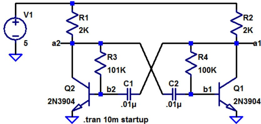
Ändern Sie die Kapazitäten  $C_1$  und  $C_2$  so ab, dass am Ausgang  $a_1$  die Einschaltzeit 0,2s und die Ausschaltzeit 0,8s beträgt. 2P
