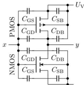
Modellierung der Gate-Kapazität. Simulator teilt die Gate-Kapazitäten hälftig in eine zum Source und zum Drain auf:
