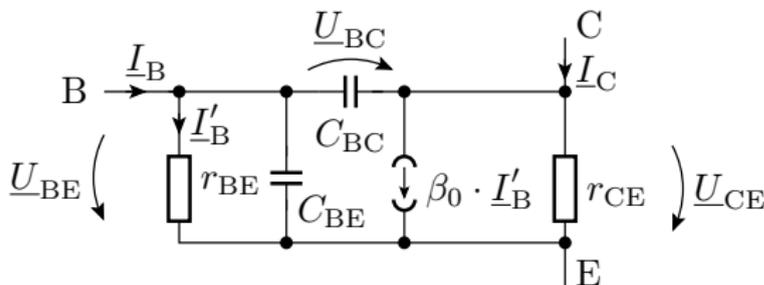
Die Übergangsfrequenz der Spannungsverstärkung ergibt sich aus der Anordnung der BE- und der CB-Kapazität in der Gesamtersatzschaltung des Verstärkers. Für die Überschlüsse soll die BE-Diffusionskapazität gegenüber der Sperrschichtkapazität vernachlässigt und die Sperrschichtkapazitäten durch die Kapazitätsparameter für Sperrspannung null angenähert werden.
