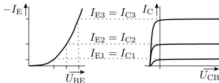
Der über  $U_{BE}$  steuerbare Diffusionsstrom vom Emitter fließt fast zu 100% weiter zum Kollektor:
