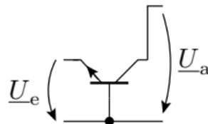
Kleinsignalverhalten mit dem Transistor im Normalbetrieb:
