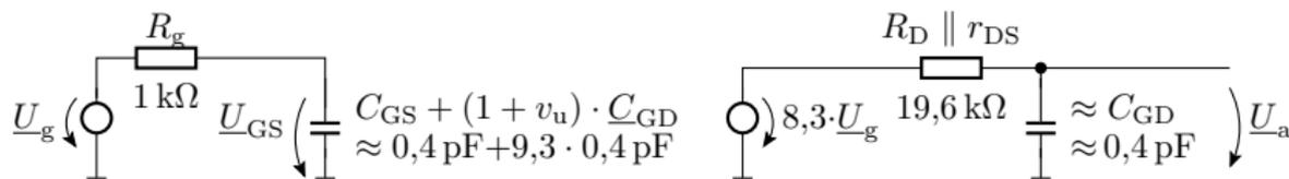
Die Übertragungsfunktion der beiden über einen Trennverstärker verketteter RC-Glieder ist:
