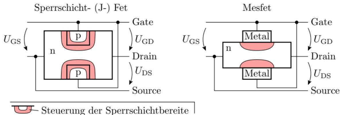
Steuerung der Kanalbreite über die Breite einer Sperrschicht:
