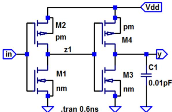
**M1:**  $l=0.8\mu$   $w=1\mu$   $ad=1.5p$   $as=1.5p$   $pd=5\mu$   $ps=5\mu$
