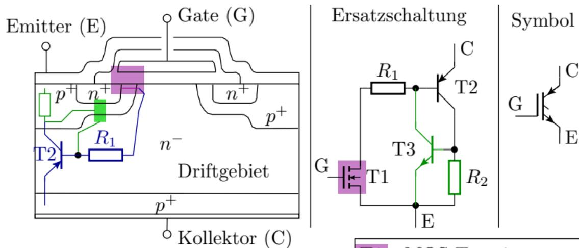
Außer dem gewollten Bipolartransistor zur Injektion von Löchern in das Driftgebiet, gibt es einen weiteren Bipolartransistor, der mit dem ersten einen Thyristor bildet.
