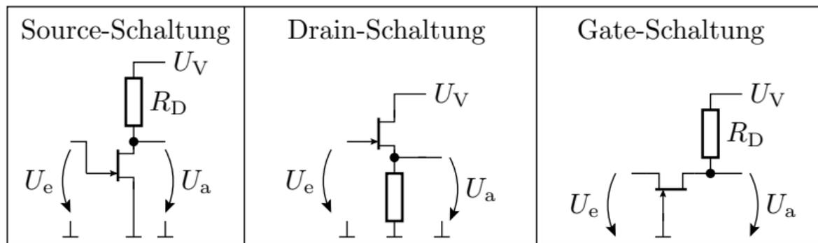
Die Grundsaltungen verhalten sich ähnlich wie bei Bipolartransistoren, nur dass der Eingangswiderstand für Gleichspannung praktisch eine Unterbrechung ist:
