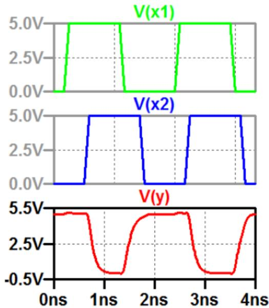
Im Vergleich zum NAND-Gatter zuvor  $4\times$ so breite PMOS-Transistoren, dadurch schneller.
