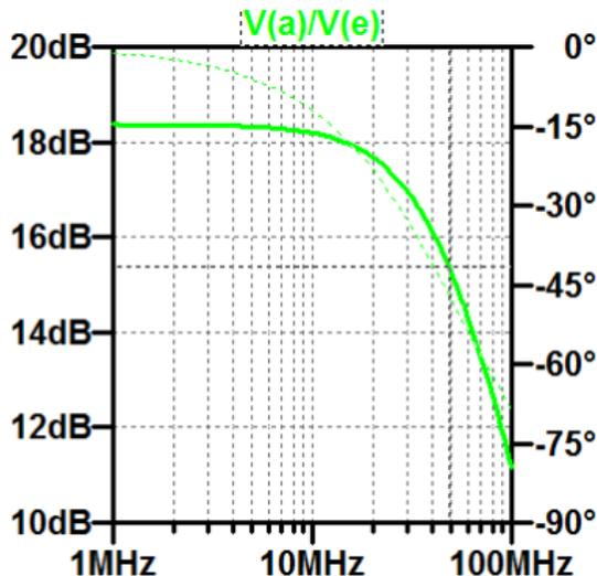
Übergangsfrequenz 49 MHz (bei der Emitterschaltung mit demselben  $R_D$  waren es 29 MHz).
