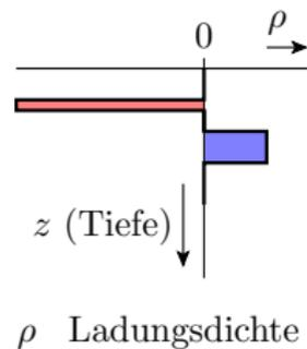
Positive Gatespannung kleiner der Einschaltspannung
