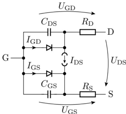
Der Stromfluss durch den Kanal wird durch eine gesteuerte Quelle modelliert. Der pn- bzw. Schottky-Übergang zur Steuerung wird durch die bereits behandelten Diodenstrom- und Diodenkapazitätsgleichungen beschrieben. Da immer im Sperrbereich betrieben, können die Diodenströme und Diffusionskapazitäten in den Überschlüssen immer vernachlässigt werden.
