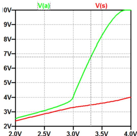
Simulationsergebnis mit »Tr« im Arbeitspunkt  $U_e = 3,3 \text{ V}$ :
