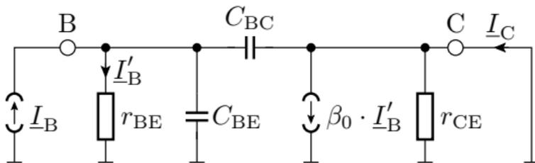
$r_{CE}$  weglassen (kurzgeschlossen).  $I_C$  - Anteil durch  $C_{BC}$  zur Vereinfachung ignorieren.  $C_{BE}$ ,  $C_{BC}$  durch Sperrschichtkapazitäten für Sperrspannung null annähern.
