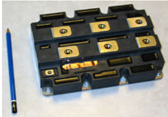
IGBT-Modul für 1,2 kA und 3,3 kV
