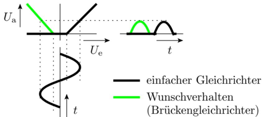
Der einfache Gleichrichter schneidet von einer Wechselspannung die untere Halbwelle ab.
