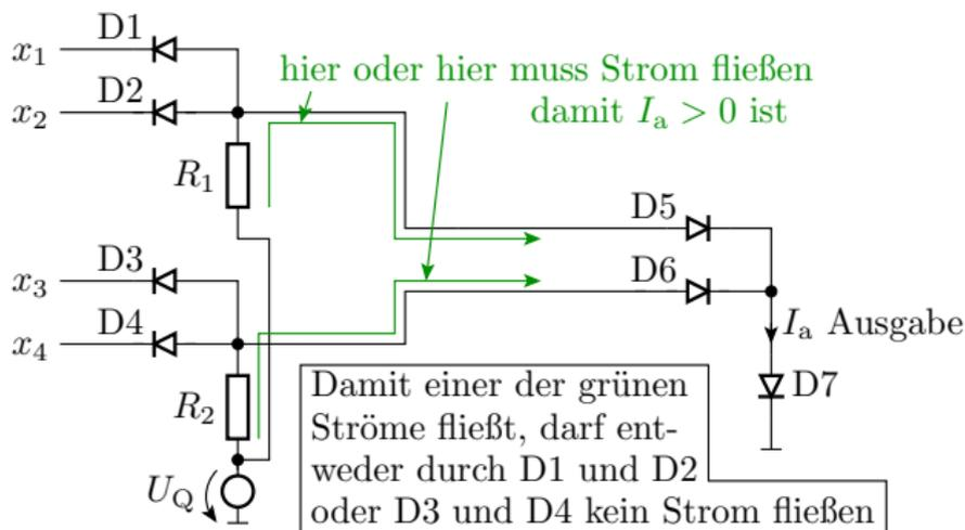
$I_a$  ist nur groß, wenn entweder die Potentiale von  $x_1$  und  $x_2$  größer als  $U_F$  sind oder wenn die Potentiale von  $x_3$  und  $x_4$  größer als  $U_F$  sind. Sonst ist  $I_a = 0$ . Logische Funktion:
