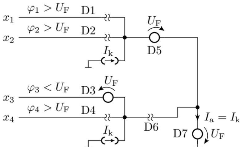
Die Dioden  $D_1$  und  $D_2$  sperren, so dass der obere Quellenstrom  $I_k$  als  $I_a$  durch  $D_7$  fließt.
