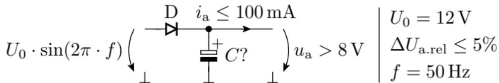
Wie groß muss der Glättungskondensator hinter der Diode sein, damit die relative Restwelligkeit der geglätteten Spannung nicht größer als 5% ist?
