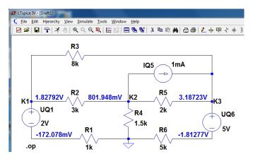
Schaltplaneingabe, Simulation starten, ... Automatische Extraktion und Lösung der Gleichungssysteme.
