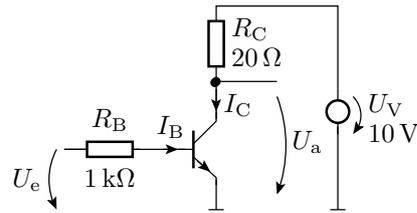
In dieser Transistorschaltung lässt sich über einen Strom  $I_B$  der Strom  $I_C$  so steuern, dass die Ausgangsspannung  $U_a$  von  $\approx 0\text{ V}$  bis  $U_V$  verändert werden kann. Für Abschätzungen der Leistung ist  $I_B \approx 0,01 \cdot I_C$  vernachlässigbar. Wie groß muss die zulässige Verlustleistung von  $R_C$  und von dem Transistor sein?
