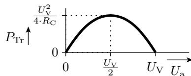
Bauteile in einer Schaltung müssen die maximale Verlustleistung vertragen!
