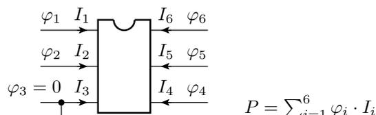
Summe der Produkte aus Potential und hereinfließendem Strom für alle Anschlüsse. Wie kann man sich das herleiten?<sup>4</sup>
