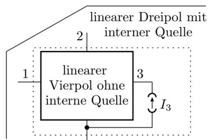
Ein Anschluss ist der Bezugspunkt. An alle anderen wird eine Spannungs- oder Stromquelle angeschlossen.
