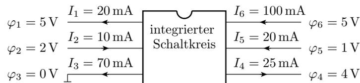
Maximale Verlustleistung: ohne Kühlkörper  $P_{V\max1} = 300 \text{ mW}$ , mit Kühlkörper  $P_{V\max2} = 1 \text{ W}$ . Benötigt der Schaltkreis den Kühlkörper<sup>6</sup>?
