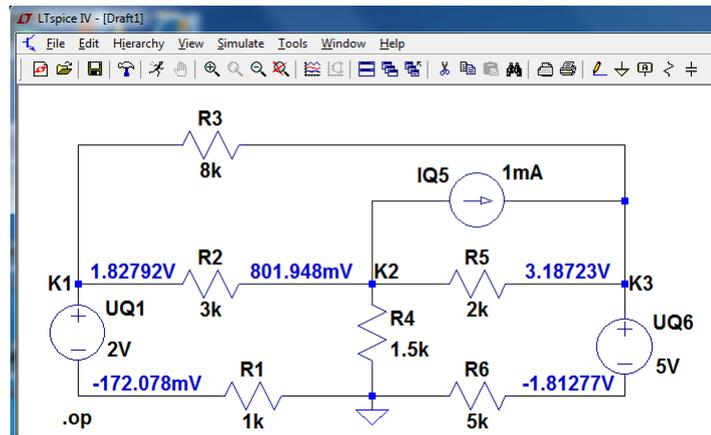
Schaltplaneingabe, Simulation starten, ... Automatische Extraktion und Lösung der Gleichungssysteme.
