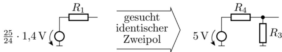
$$\frac{R_3}{R_3 + R_4} \cdot 5 \text{ V} = \frac{25}{24} \cdot 1,4 \text{ V}$$
