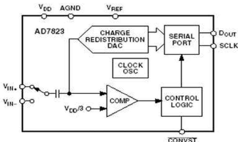
( $V_{IN-}$ ,  $V_{IN+}$ ,  $V_{REF}$  - Spannungen zwischen dem gleichnamigen Eingängen und AGND (Masse). Im Versuchsaufbau sind  $V_{REF} = 3,3V$ ,  $V_{IN-} = 0V$  und  $V_{IN+}$  über ein kleines Potentiometer zwischen  $V_{IN-}$  und  $V_{REF}$  einstellbar.
