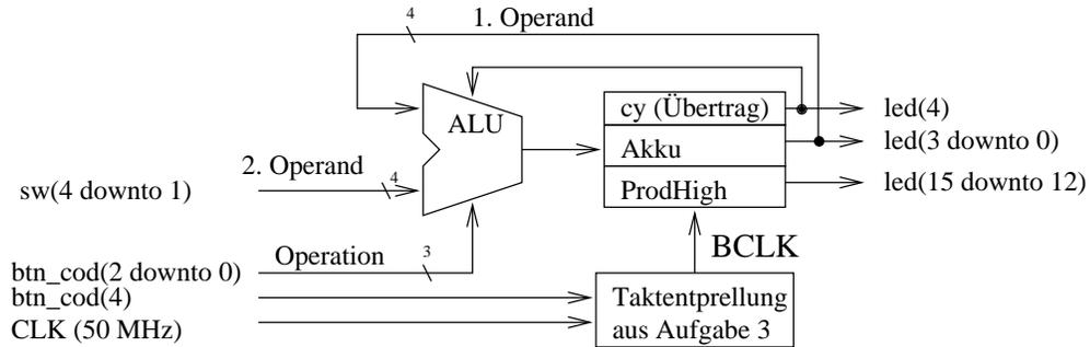
Die ALU (arithmetic logic unit, Rechenwerk) soll in Abhängigkeit von der Nummer der gedrückten Taste folgende Funktionen ausführen:
