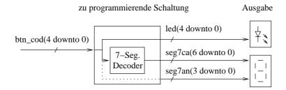
Die Daten von den 16 Tastern werden aus dem CoolRunner auf dem dio (Daughter IO-Board) in folgender Codierung an die Hauptplatine ausgegeben:
