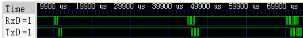
1-Byte-Paket nach ca. 10 ms, 2 Byte-Paket nach ca. 50 ms und 3-Byte-Paket nach ca. 75 ms. Vergrößertes 2-Byte-Paket:
