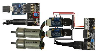
Anschluss Motoren, PModUSBUSART, USB-Kabel zum PC, ...:
