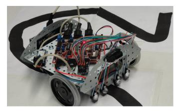
Zählen der Winkelschritte an beiden Antriebsrädern. Erweiterbar zu einer 2D+R-Positionsbestimmung<sup>3</sup>.
