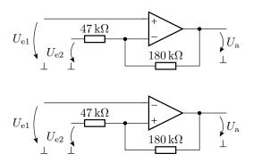
Unterstellen Sie für die Rechnung "idealer Operationsverstärker": Verstärkung unendlich, Eingangswiderstand unendlich etc..
