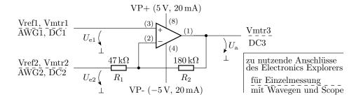
Bestimmen Sie für zwei Werte von  $U_{e1} \in \{2,5\,\mathrm{V},\,3,5\,\mathrm{V}\}$  die Übertragungsfunktion  $U_{a} = f\left(U_{e2}\right)$  im Bereich  $0 < U_{e2} < 5\,\mathrm{V}$ . In welchem Bereich der Differenzeingangsspannung  $U_{\mathrm{Diff}} = U_{e2} - U_{e1}$  verhält sich die Ausgangsspannung  $U_{a}$  proportional zur Differenzeingangsspannung?
